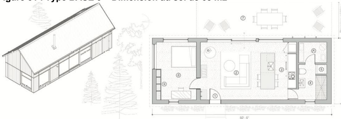
Figure 32 : Type BASE 1 – Dimension au sol de 93m<sup>2</sup>
