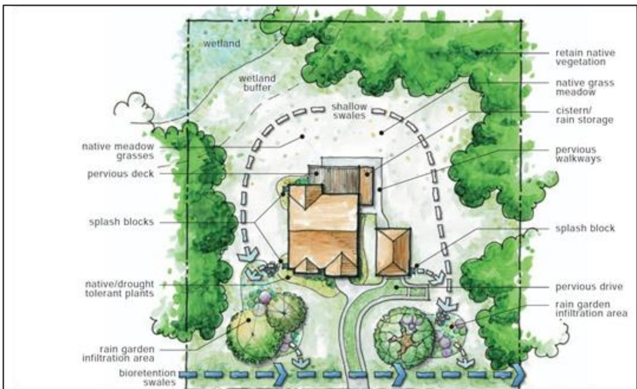
Figure 18 : Exemple d'un drainage d'eaux pluviales vers des jardins d'eau (Source : AHBL)
